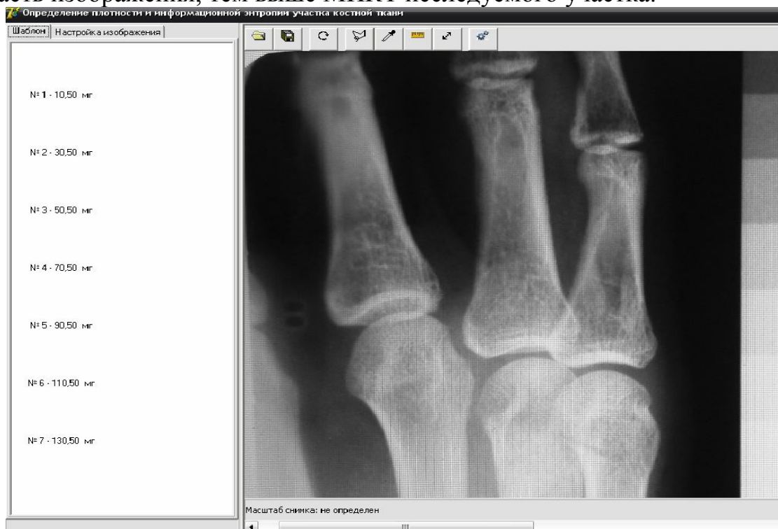
Рисунок 1 – Фрагмент экранной формы с изображением рентгеновского снимка участка костной ткани (кисть человека), алюминиевого шаблона (слева) и результат калибровки плотности его ступеней (числа справа)
