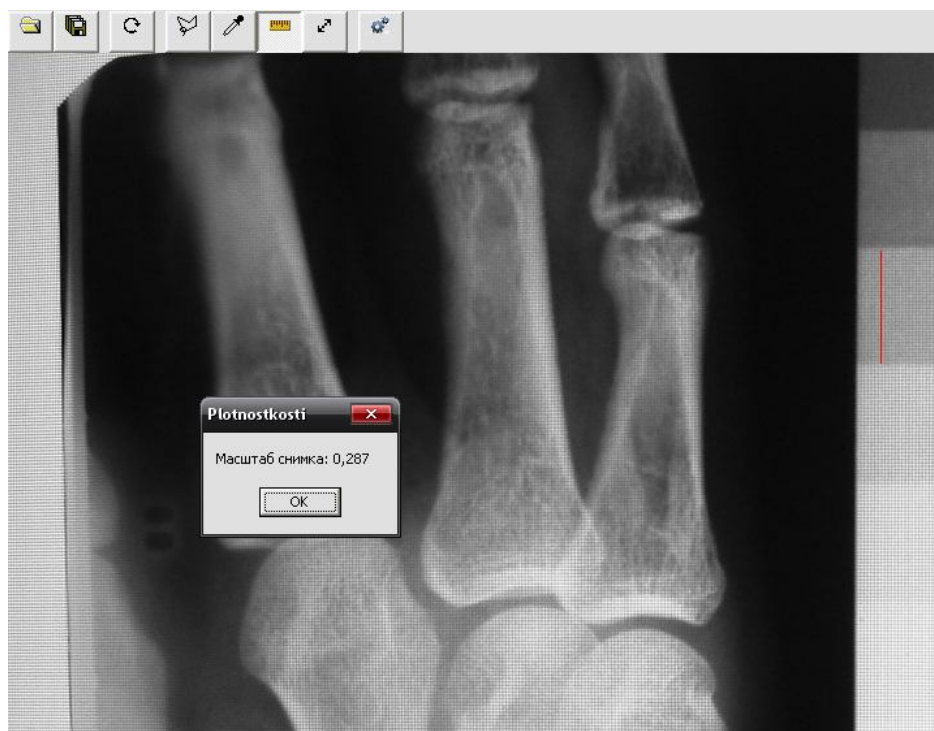
Рисунок 3 – Результат масштабирования рентгеновского снимка. На изображении шаблона (справа) вертикальной линией показан отрезок единичной длины, полученный с помощью мыши
