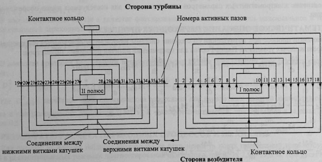
Рисунок 2 – Схема катушечных соединений обмотки возбуждения турбогенератора ТГВ-200М
