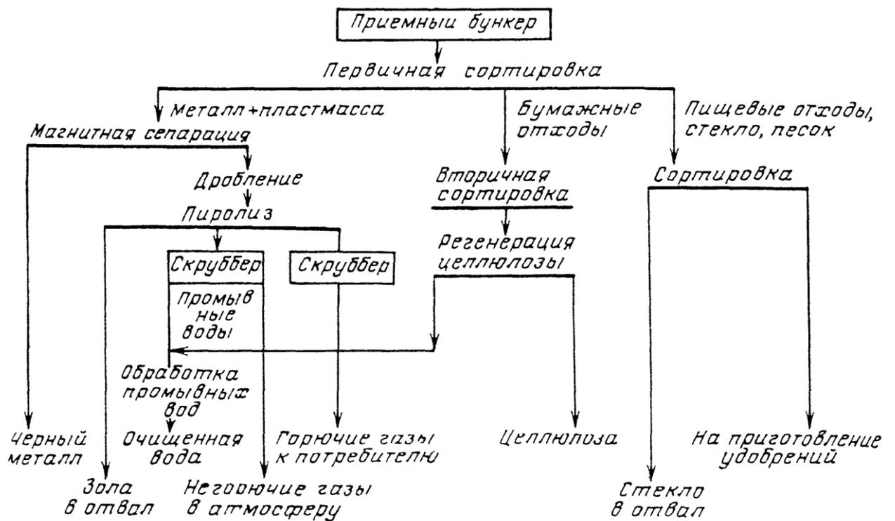
Рис. 1 – Пример «мокрой» технологической схемы обогащения
