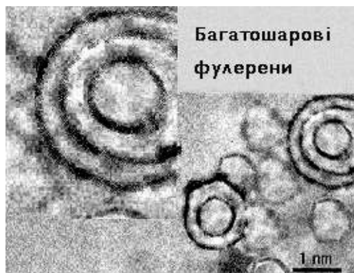
Рис. 1.7. – Фотографія багатошарових фулеренів
