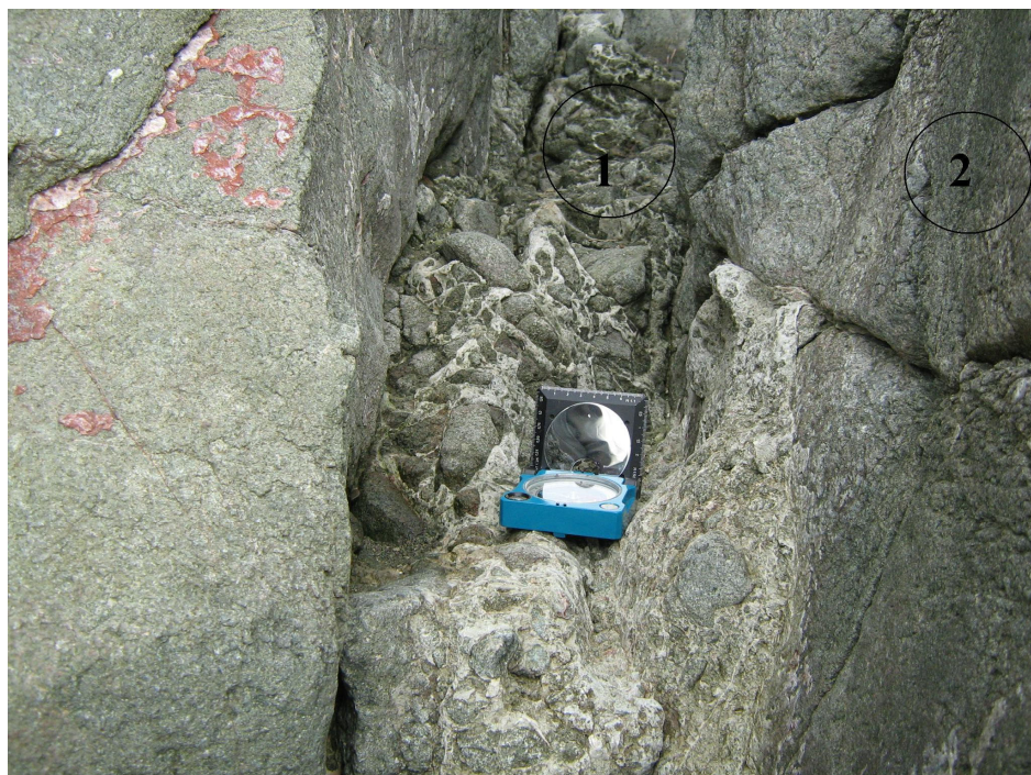
Рис.2. Разрывное нарушение (1) в вулканитах средней юры (2), выраженное тектонической брекчией с карбонатными минералами и цеолитами в цементе брекчии
