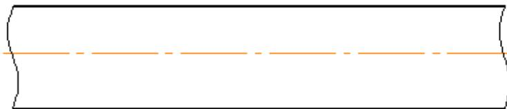
Рисунок 68. Создание волнистой линии обрыв по двум указанным крайним точкам.
