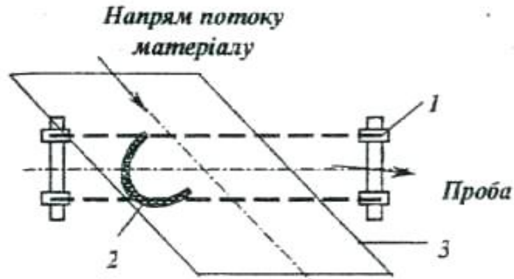
Рис. 9.4 – Схема відбору проб скреперним пробовідбірником
