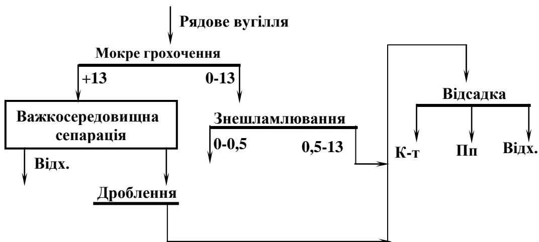
Рис. 6.40 - Схема спільного збагачення відсадкою дрібного класу і дробленого продукту важкосередовищної сепарації після відділення породи.
