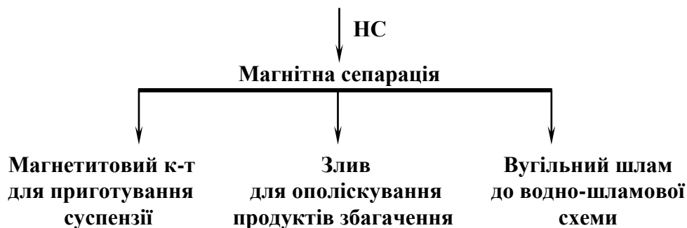
Рис. 6.33 – Одностадійна схема магнітної регенерації некондиційної магнетитової суспензії.
