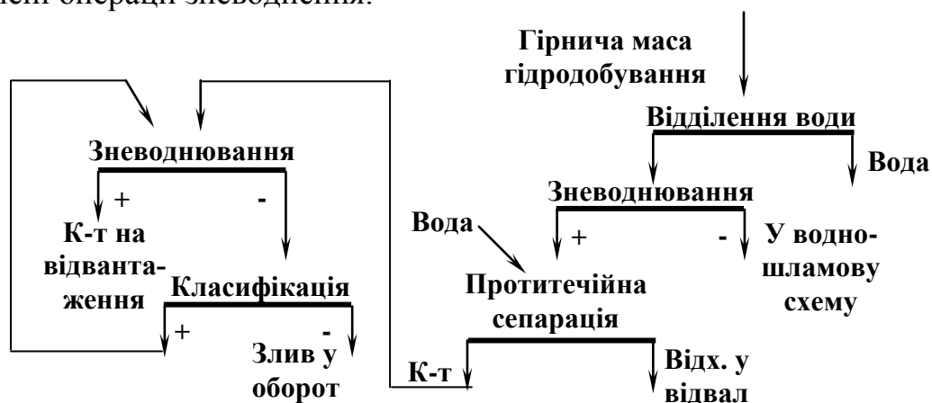
Рис. 6.42 – Одностадійна схема збагачення енергетичного і розубоженого (збідненого) вугілля протитечійною сепарацією.
