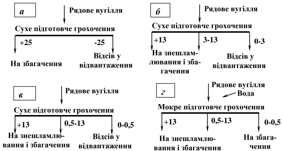
Рис. 6.27 – Схеми підготовчих операцій.
