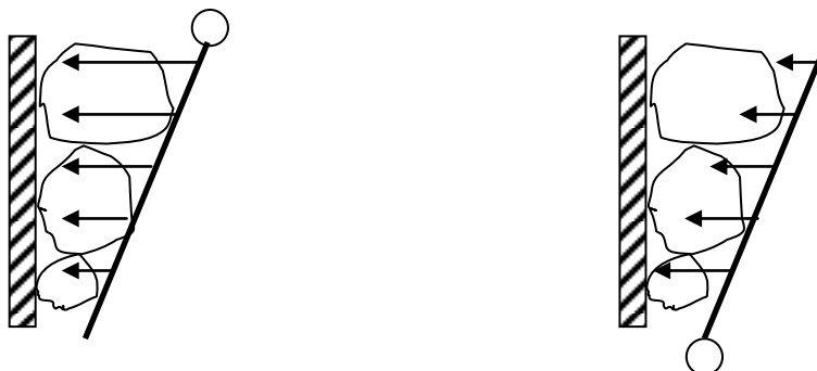
Рисунок 2.10 – Распределение усилий при разных способах подвеса подвижной щеки
