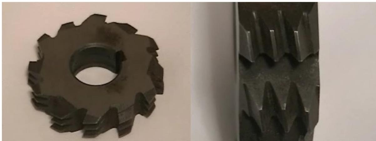
Рис.2 Гиперboloидная многозаходная зубчатая фреза
