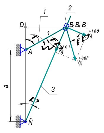
Кулисный механизм используется для передачи вращательного движения с одной оси на другую с переменным передаточным отношением.
