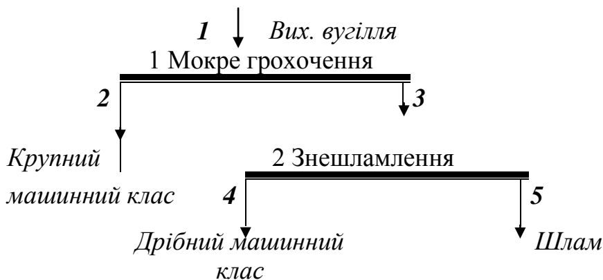
Рис. 2.2 - Схема комплексу підготовки вугілля до збагачення
