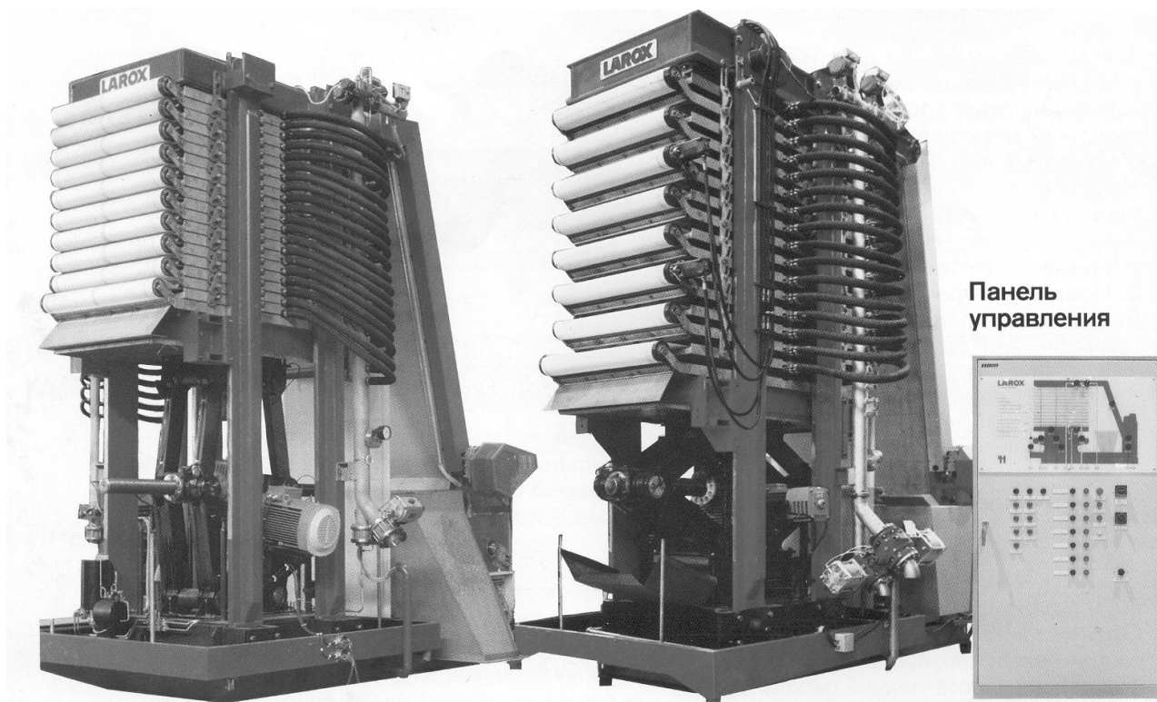
Рис. 8.1. Вертикальный фильтр-пресс в сомкнутом (слева) и разомкнутом (справа) состоянии
