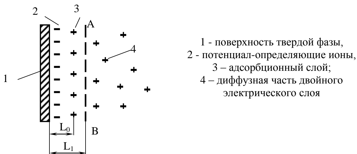
Рис. 17.5. Схема строения двойного электрического слоя
