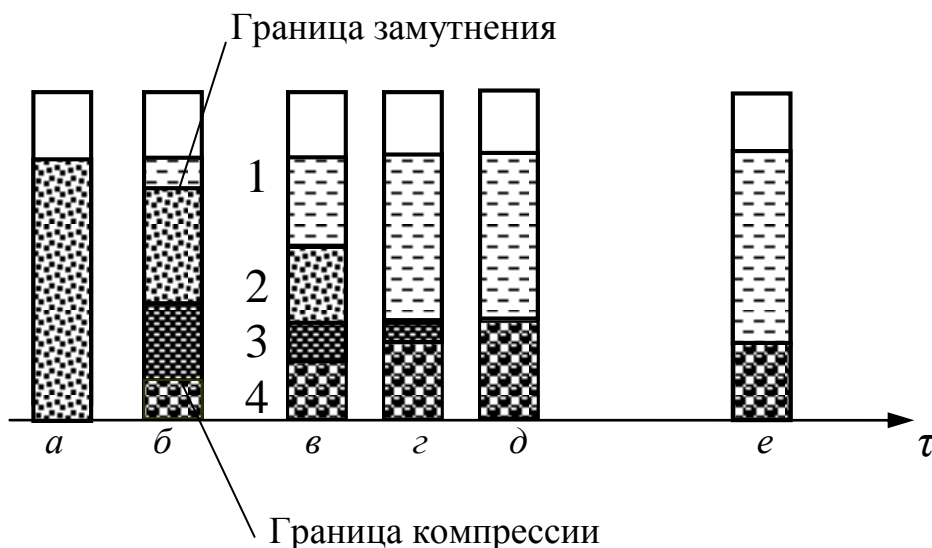
Рис. 16.2. Процессы, происходящие при осаждении
