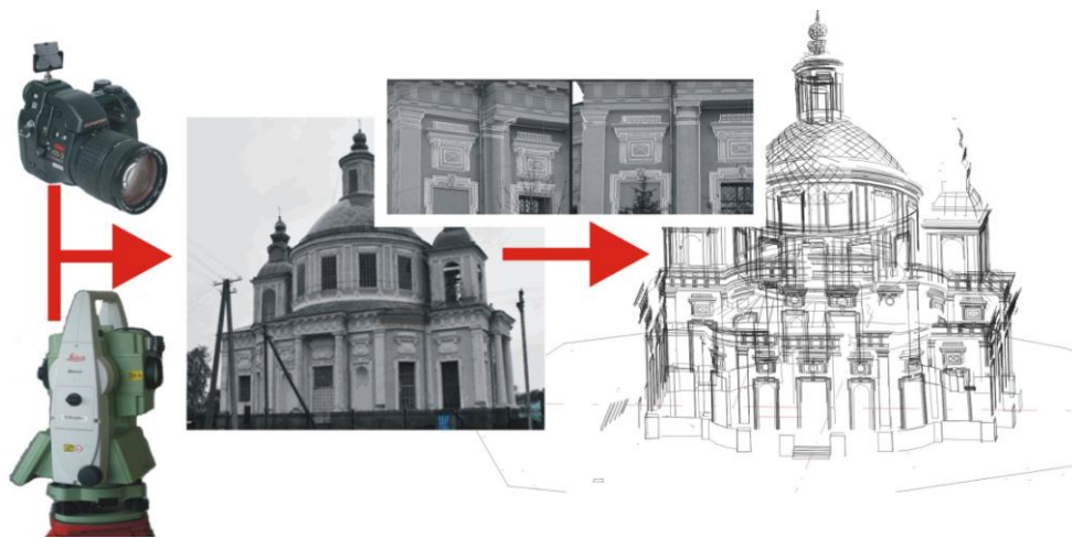
Рисунок 1 - Технологія одержання тривимірної моделі
