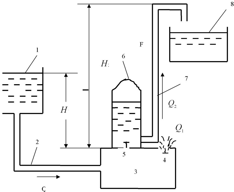
Рис.1. Схема гидротаранной установки: 1- водоисточник, 2 – питательный трубопровод, 3 – рабочая коробка, 4 – ударный клапан, 5 – нагнетательный клапан, 6 – водовоздушный колпак, 7 – нагнетательный трубопровод, 8 – приемный резервуар.
