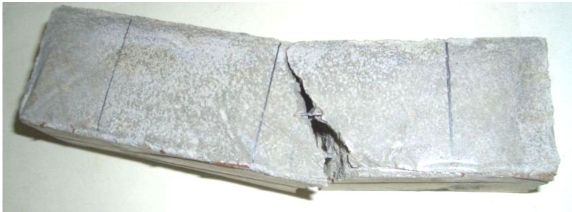
Рис. 7. Вид бетонного зразка, армованого 2 % металевих фібр після проведення випробувань на розтягання при вигині.
