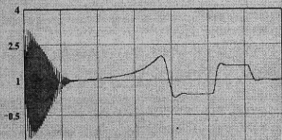
Рисунок 2 – Результаты моделирования режимов пуска, сброса и наброса нагрузки по разработанной математической модели
