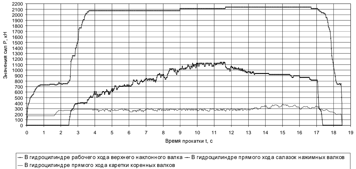
Рисунок 2 – Графики сил при прокатке колес Ø957 мм
