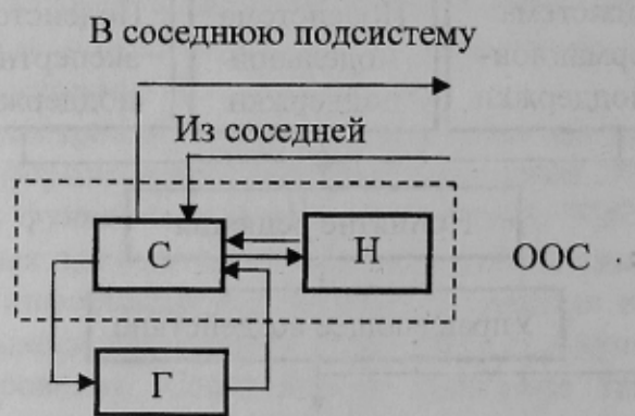
Рисунок 4 - Подсистема как многомерный электрический объект
