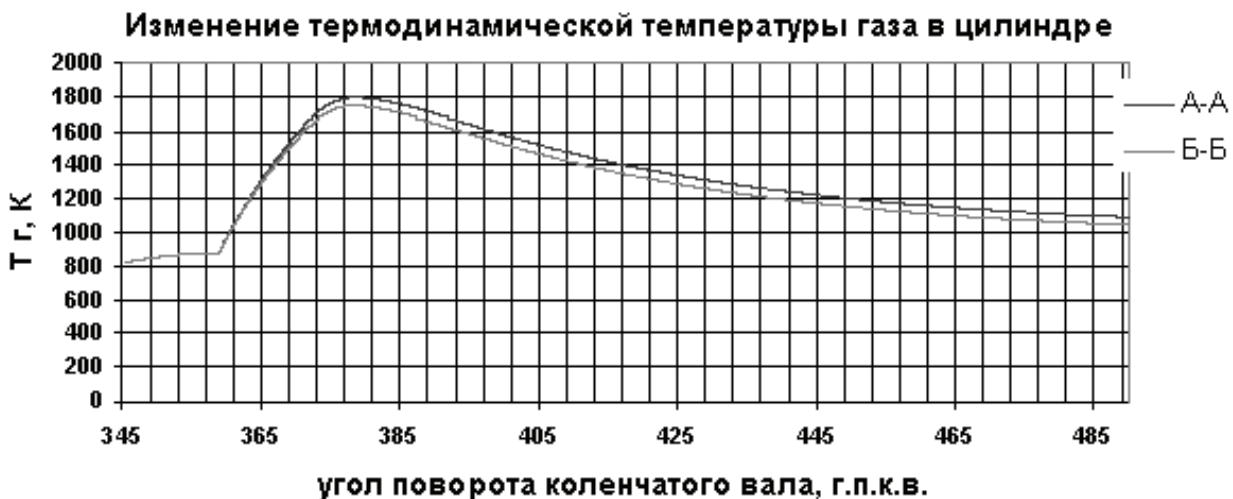
Рис. 11. Изменение угла термодинамической температуры в камере сгорания в зависимости от сечения камеры сгорания дизеля
