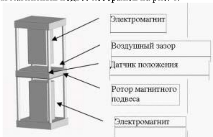
Рисунок 1 – Схема магнитного подвеса
