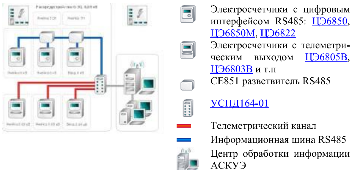
Рисунок 1 – Автоматизированная система контроля и учета электроэнергии
