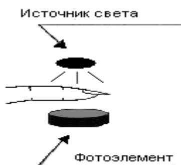
Рисунок 2 – Конструкция пульсоксиметрических датчиков
