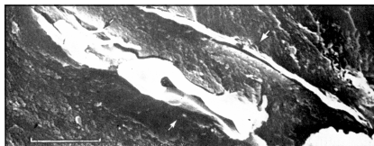
Ліптиніт. Мегаспора (стрілка вгору) та мікроспора (стрілка вниз) на вертикальній поверхні сколу вугілля низької стадії вуглефікації. С 1 . Західний Донбас. Скануючий електронний мікроскоп, x2000. Шкала 10 мкм.
