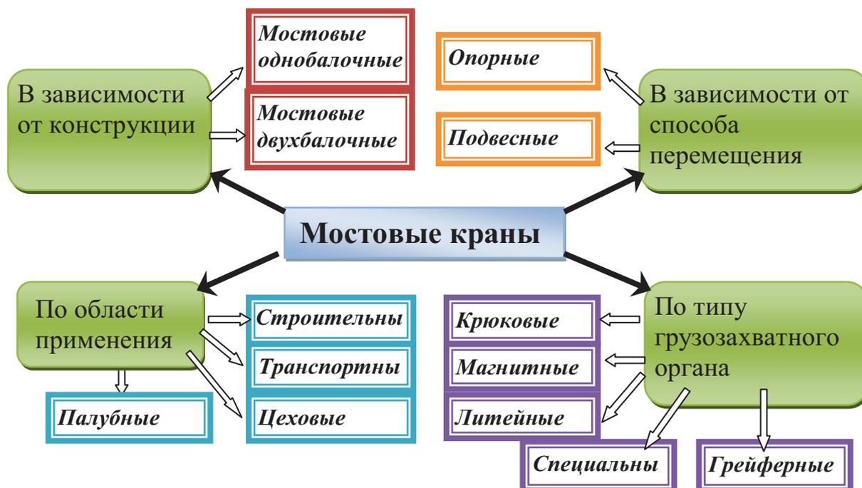
Рис. 1. Классификация мостовых кранов
