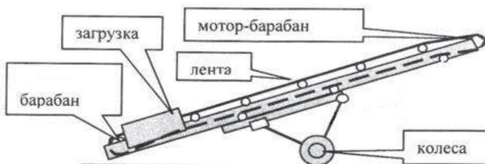
Рис. 1. Конвейер передвижной ленточный
