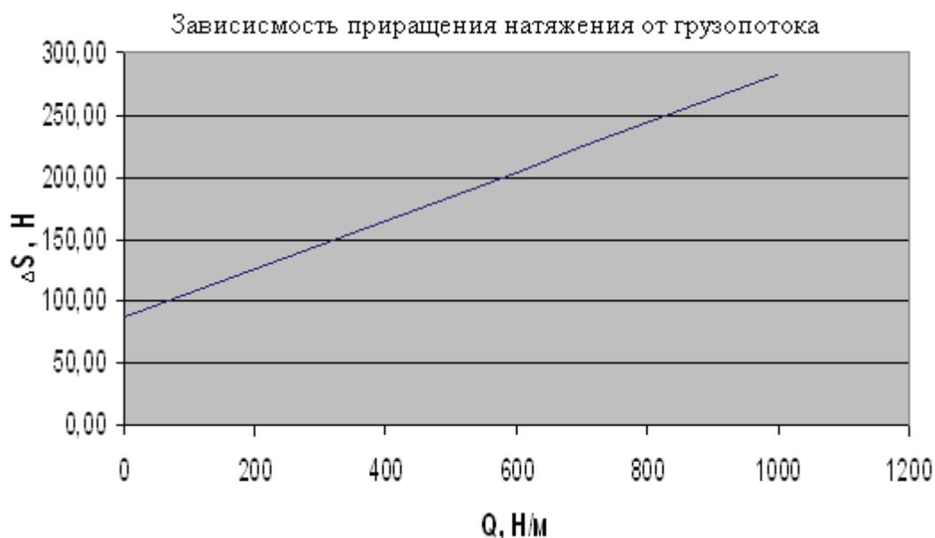
Рис. 3. Зависимость приращения натяжения от грузопотока.
