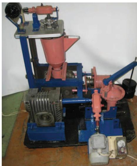
Рис. 3 Лабораторный двухвалковый пресс
