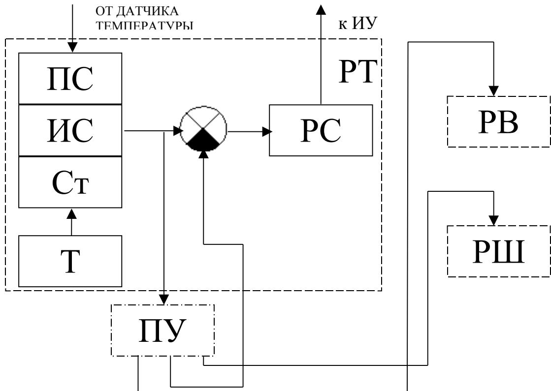
Рисунок 1 – Структурная схема взаимосвязи разрабатываемого устройства с регулятором Р25
