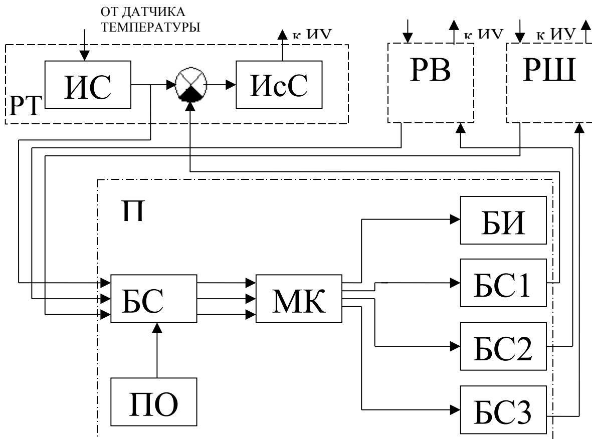
Рисунок 2 – Структурная схема проектируемого устройства
