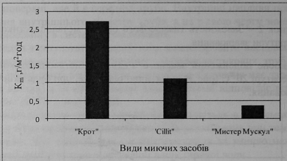
Рисунок 4 – Залежність показника зміни маси металопластикових труб (без захисту алюмінієвого шару) від виду миючого засобу
