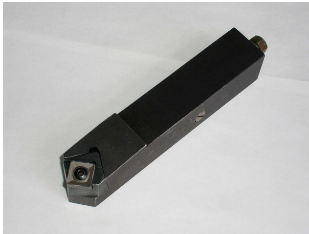
Рис. 1. Общий вид резца с быстросменной рабочей частью
