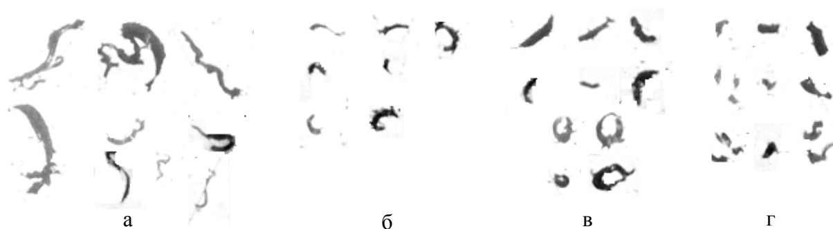
Рис. 3. Виды стружек, образующихся при плоском алмазном шлифовании: а – ленточная; б – запытообразная; в – сегментообразная; г – дробленая
