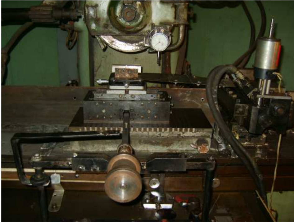
Рис. 2. Загальний вигляд пристрою для шліфування за пружною схемою з накладенням вібрацій на заготовку
