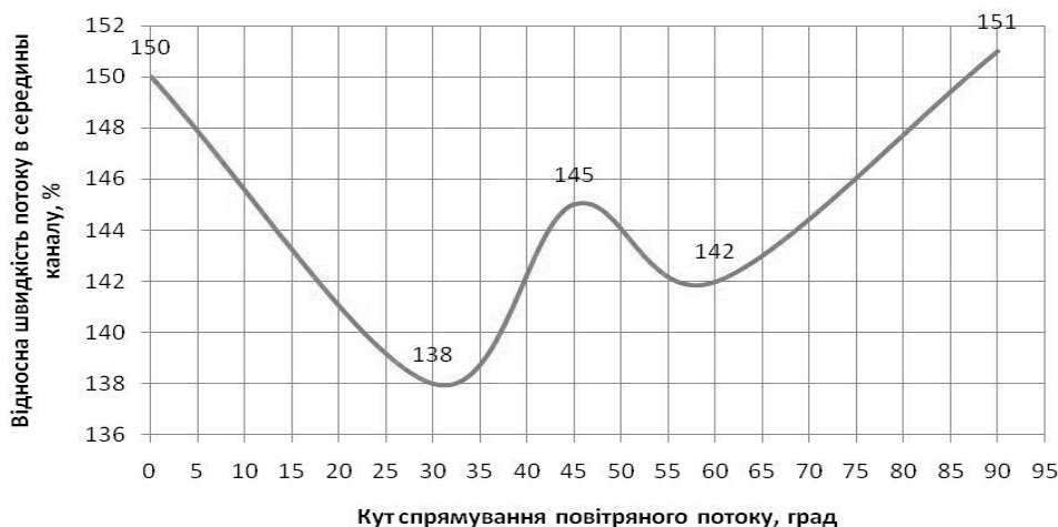
Рисунок 8 – Графік залежності відносної швидкості вітрового потоку в середині каналу від кута спрямування
