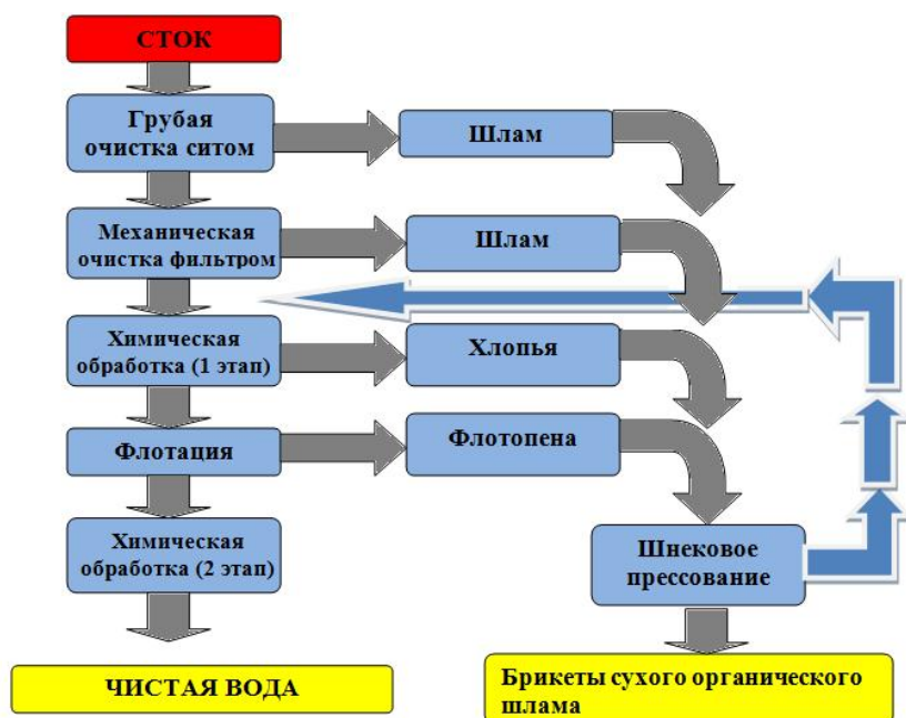
Рисунок 1 – схема закрытого цикла водоочистки
