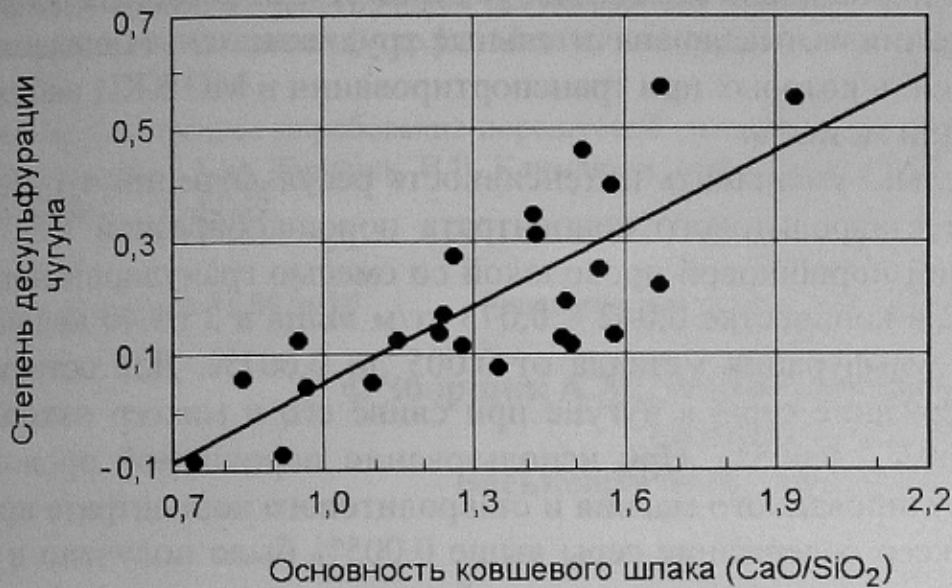
Рисунок 3. – Зависимость степени десульфурации чугуна за время выпуска и транспортирования ковшей в ОДЧ «ММК им. Ильича» от основности ковшевого шлака
