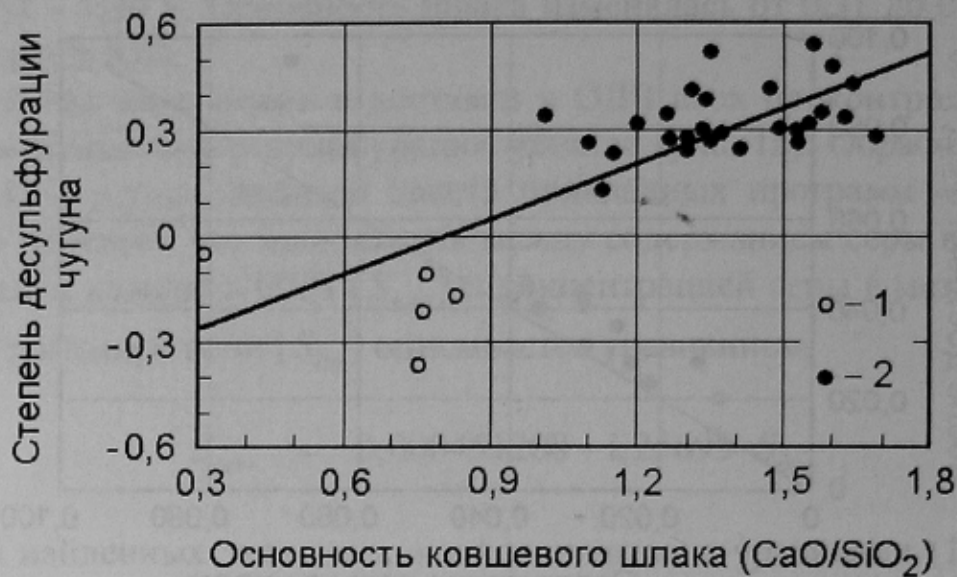
Рисунок – 2. Зависимость степени десульфурации чугуна за время выпуска и транспортирования ковшей в ОДЧ «МК «Азовсталь» от основности ковшевого шлака: 1 – ковши без обработки ИРС-2; 2 – ковши, обработанные ИРС-2
