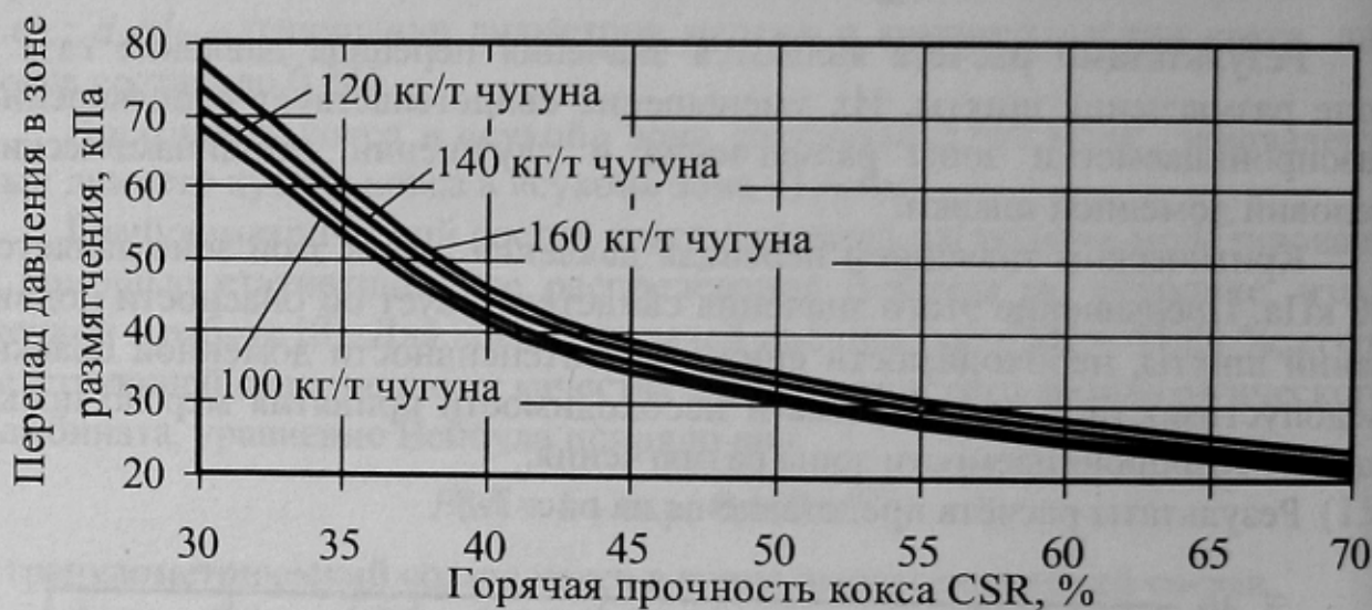
Рисунок 5 – Влияние горячей прочности кокса на газопроницаемость зоны размягчения (числа у кривых – расход ПУТ).
