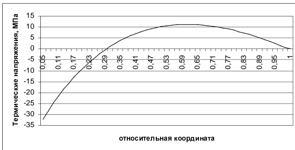
Рисунок 2 – Распределение термических напряжений по сечению закристаллизовавшейся составляющей непрерывнолитого слитка на выходе из кристаллизатора
