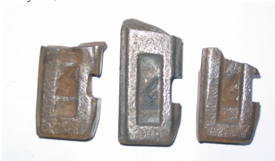
Рис. 1 – Характерные поломки режущего инструмента
