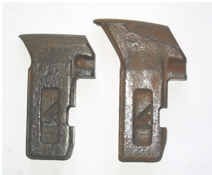
Рис. 3 – Характерный износ режущего инструмента
