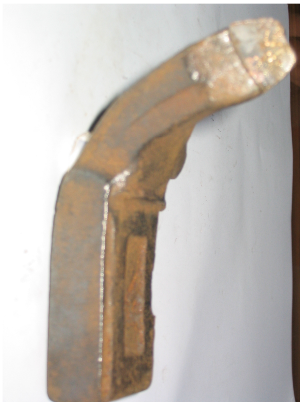
Рис. 2 – Изгиб режущего инструмента при боковом приложении нагрузки
