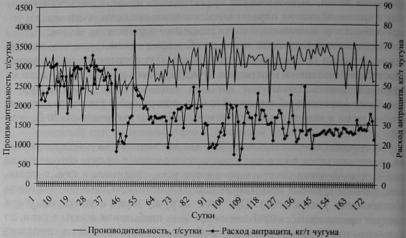
Рисунок 1 – Изменение производительности и расхода антрацита по времени на ДП№3 (1386 м) ОАО «АМК»
