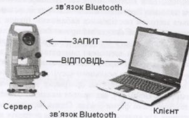
Мал. 1. Взаємодія вимірювального пристрою та комп'ютера
