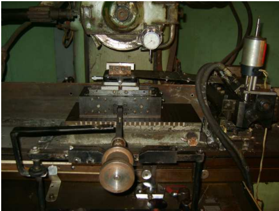
Рисунок 2 – Загальний вигляд пристрою для шліфування за пружною схемою з накладенням вібрацій на заготовку
