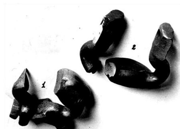
Рисунок 1 – Характер усталостного разрушения соединительных звеньев.
