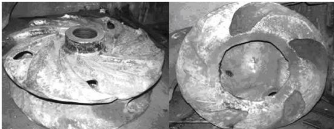
Рис.1 Рабочее колесо углесоса марки WARMAN 10/8F-АН со следами абразивного износа
