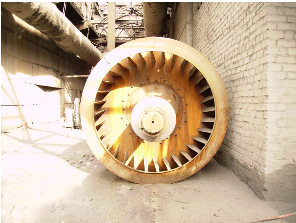
Рисунок 34 – Робоче колесо з валом у зборці
