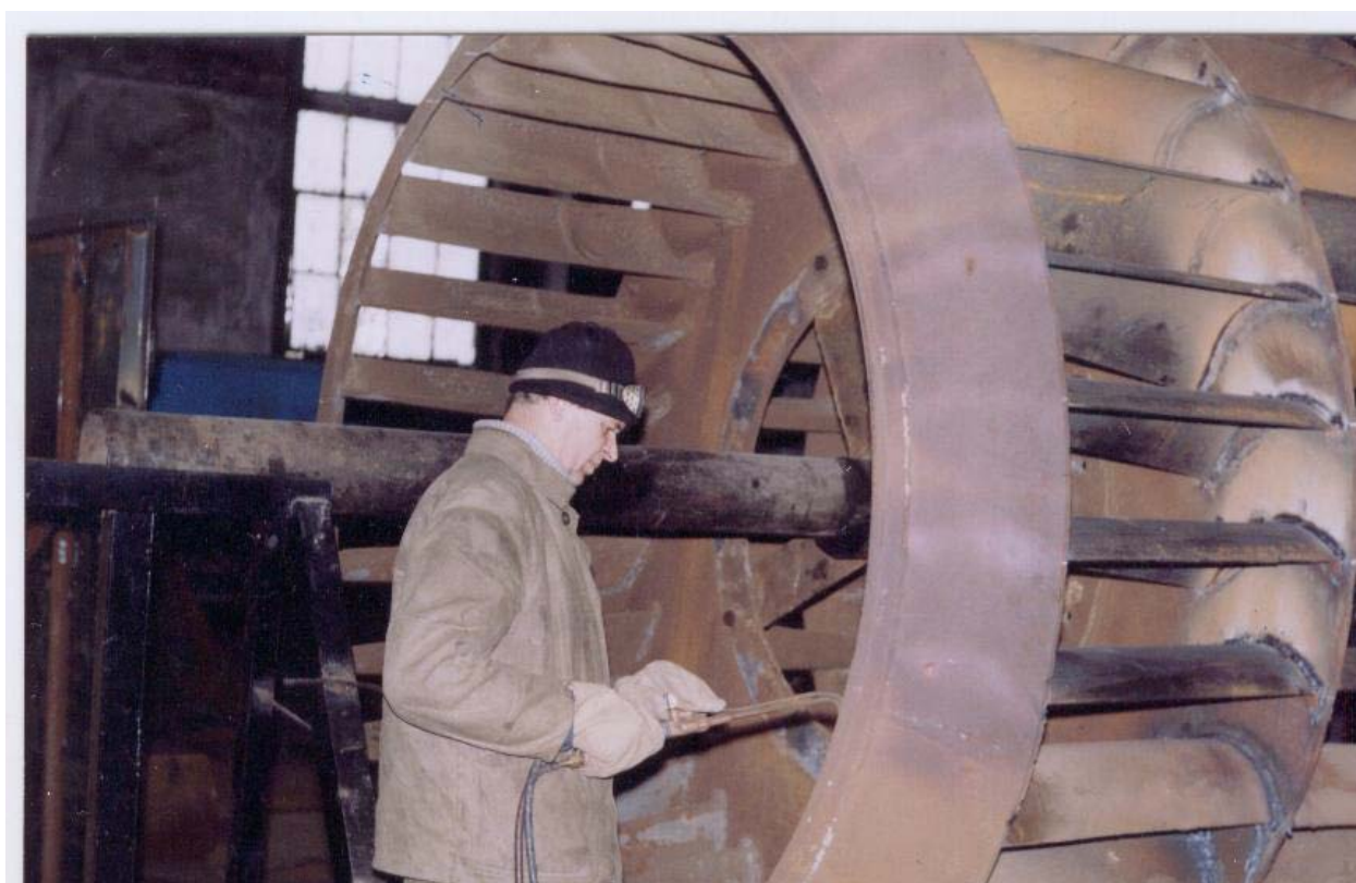
Рисунок 35 – Робоче колесо під час ремонту
