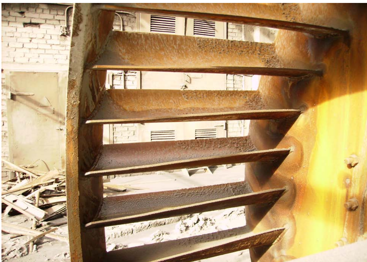
Рисунок 33 – Лопатки рабочего колеса димососу
