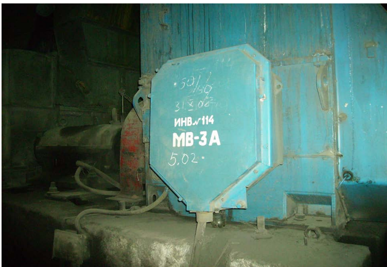
Рисунок 25 – Зовнішній корпус мельничного вентилятора
