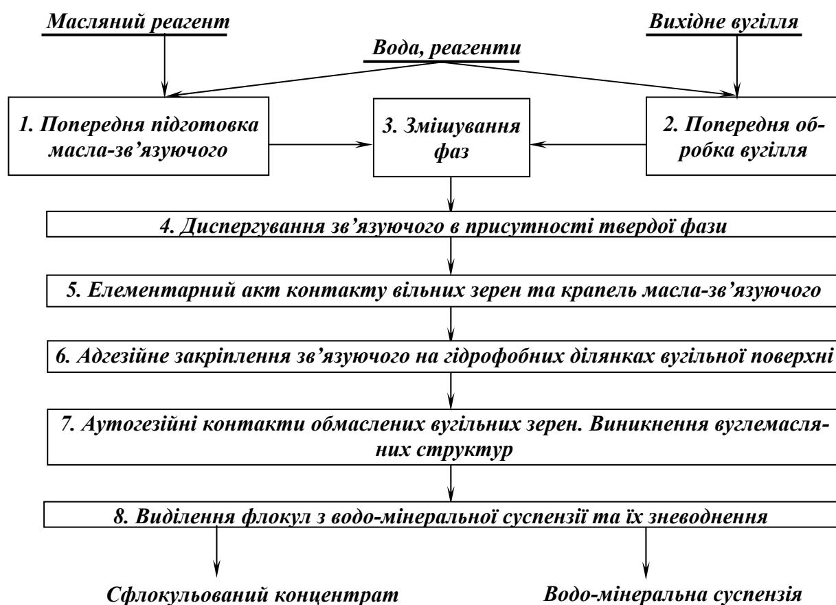
Рис. 7.3. Феноменологічна модель процесу масляної флокуляції.
