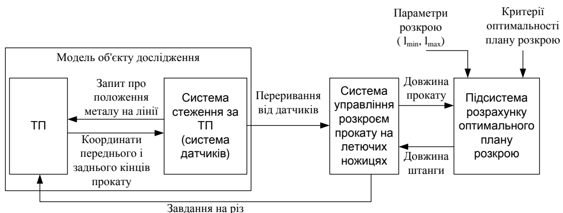
Рисунок 5 – Взаємодія підсистеми оптимізації плану розкрою з системою розкрою металопрокату
