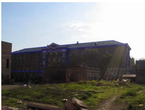
Рис.4 – Разметка опорных отрезков на фотографическом изображении
