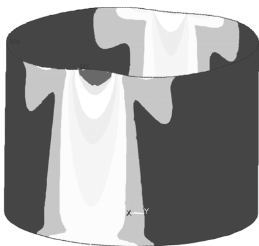
Рис. 2. Напряженно-деформированное состояние гладкой секции обсадной колонны.
