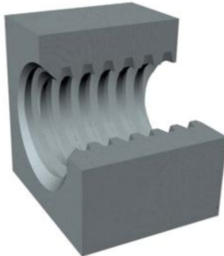
Рис. 8. Гвинтова нарізка трапецеїдальної різьби в отворі
