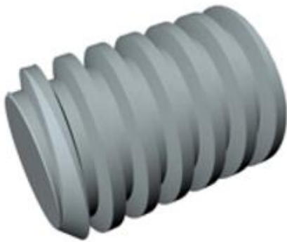
Рис. 7. Гвинтова нарізка трапецеїдальної різьби на стрижні
