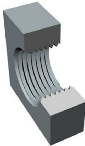
Рис. 4. Гвинтова нарізка метричної різьби в отворі
