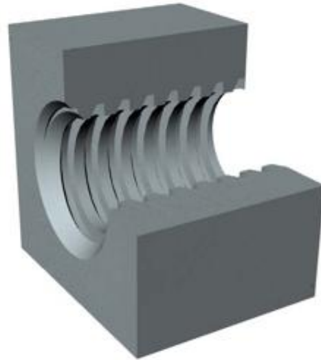
Рис. 12. Гвинтова нарізка упорної різьби в отворі
