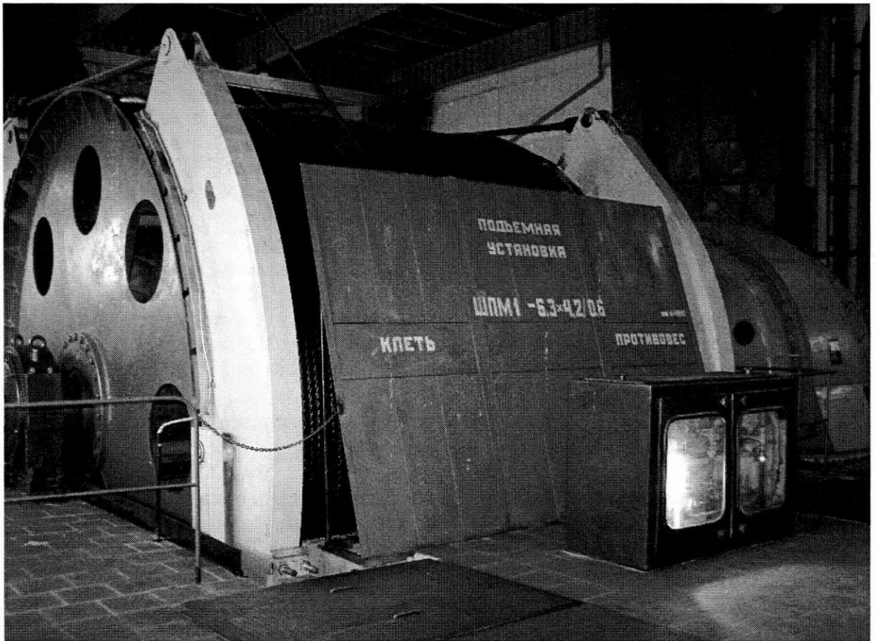
Рисунок 9.3 - Піднімальна машина з одним циліндричним розрізним барабаном 1-6,3 x 4,2/06
