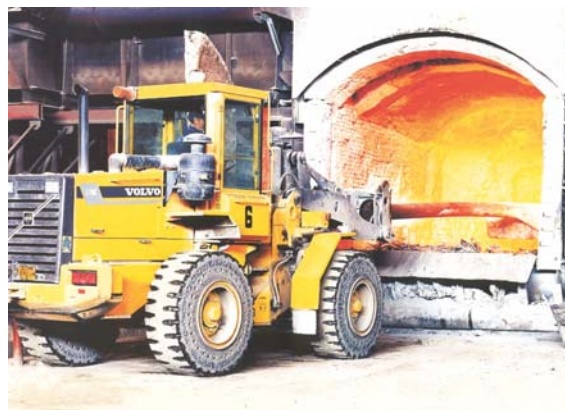
Рисунок 6.6 – Процес перемішування розплаву (викачування шлаку) у відбивній печі
