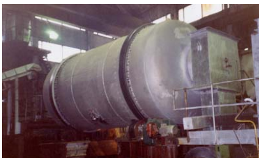
Рисунок 6.12 – Роторна піч місткістю 16 т алюмінію (вигляд з боку газоходу)
