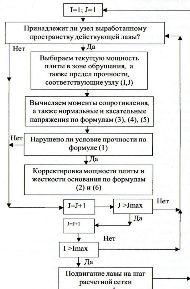
Рис. 3. Блок-схема алгоритма моделирования процесса обрушения кровли и ее самоподбуктовки
