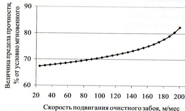
Рис. 4. Зависимость приведенного предела прочности на растяжение от скорости подвигания лавы
